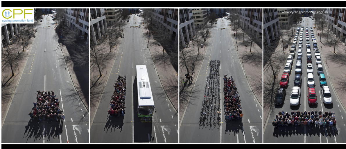
Abbildung 7.2: Flächenverbrauch von verschiedenen Verkehrsmitteln. Dargestellt ist immer die selbe Anzahl der Personen in verschiedenen Verkehrsmitteln. (Quelle: Cycling Promotion Fund Canberra)
